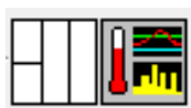
Rys. 6. Widok ikony/złącza przykładowej aplikacji LabVIEW: z lewej strony widok złącza (terminala połączeniowego), z prawej strony widok ikony
