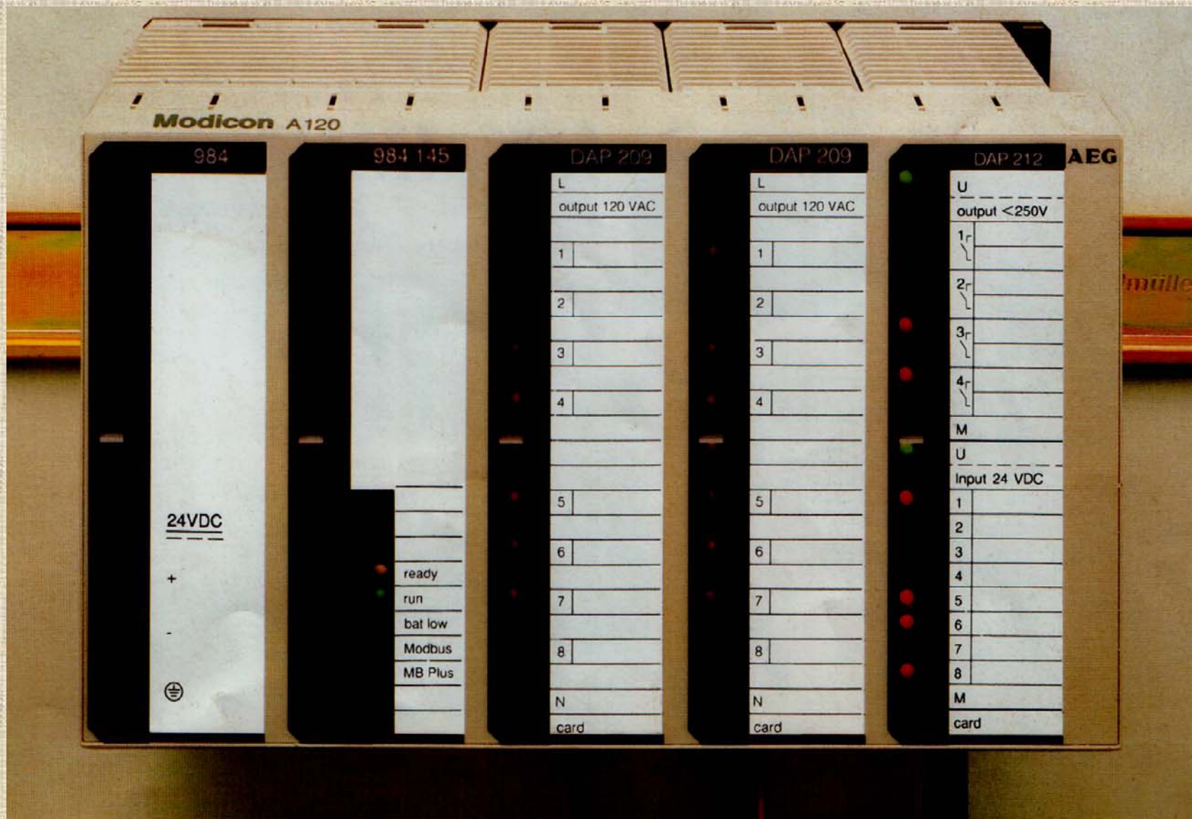
Rys. Mały modułowy sterownik PLC Modicon 984-120 Compact kompatybilny programowo z Modicon Micro
