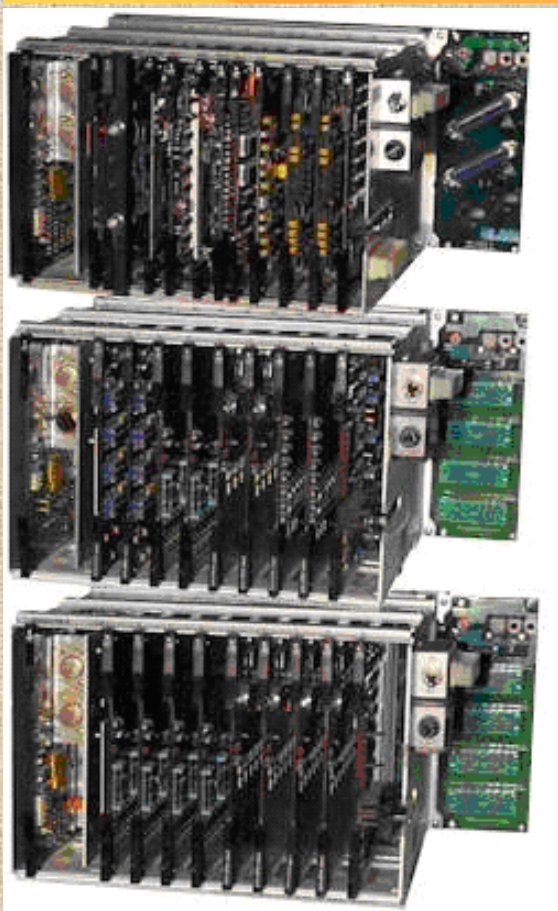
Rys. Regulatory BC (Basic Controllers) rozproszonego systemu sterowania Honeywell TDC 2000 (1975)
