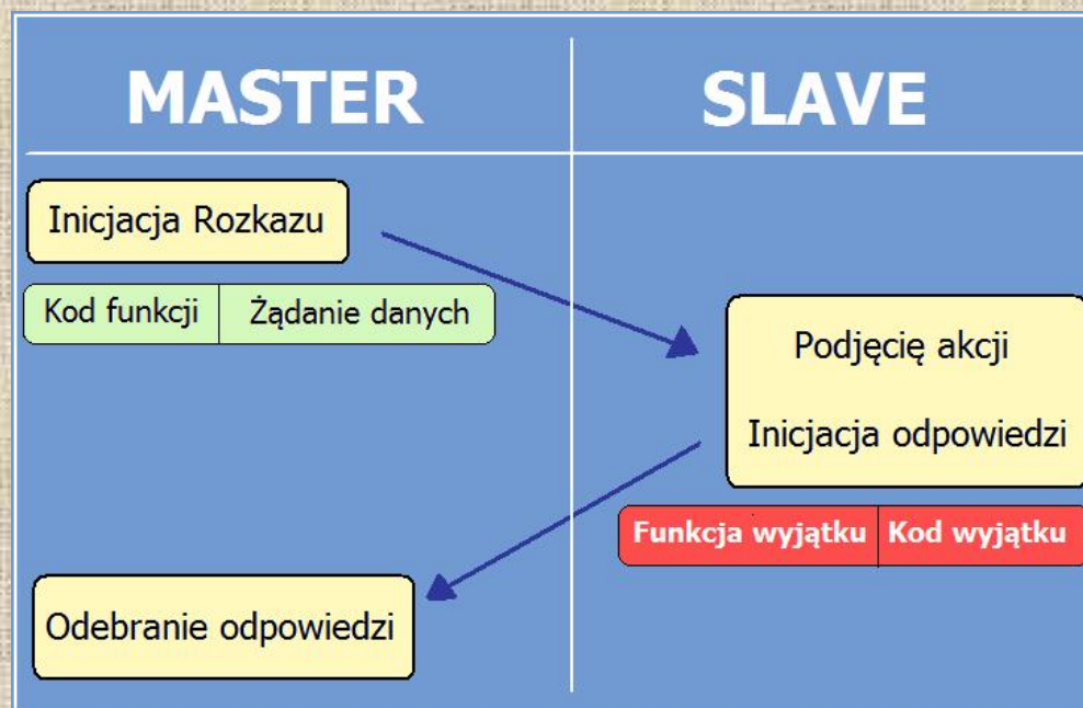
Rys. Schemat rozkazu i odpowiedzi przy wystąpieniu błędu.
