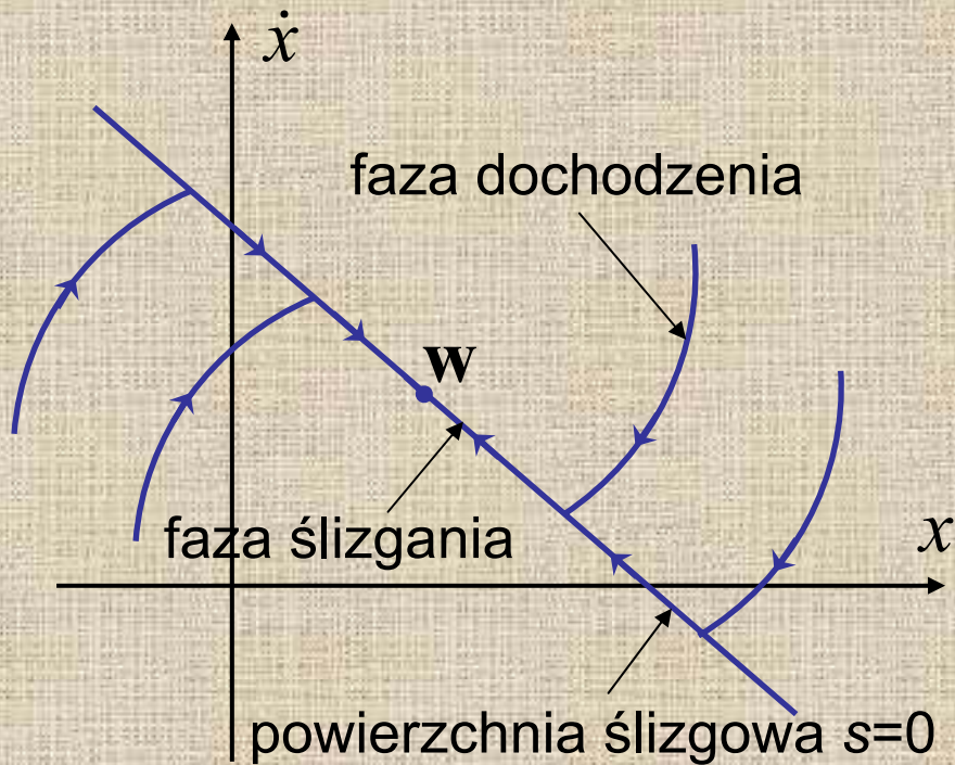
Rys. Przebieg regulacji ślizgowej w przypadku idealnego ślizgania
