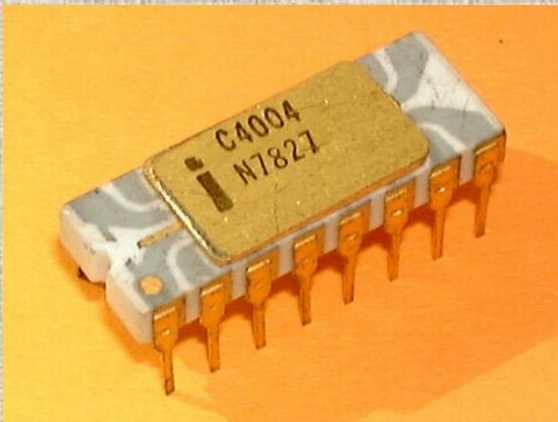
Rys. Pierwszy mikroprocesor Intel 4004 (1972)
