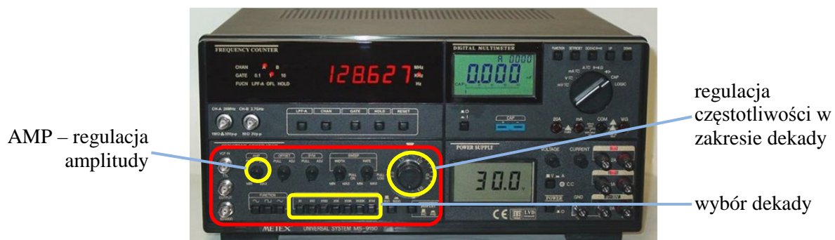
Rys. 3.1. Panel generatora funkcyjnego uniwersalnego przyrządu laboratoryjnego
