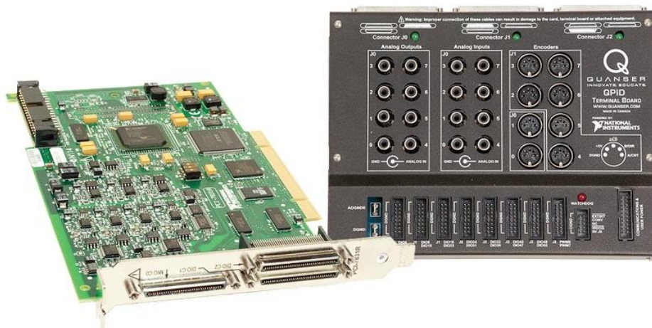
Rys. 2.5. Karta pomiarowo-sterująca QPID i panel łączeniowy karty - QPID Terminal Board
