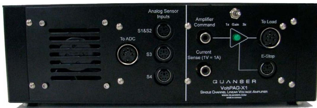
Rys. 2.5. Panel czołowy liniowego napięciowego wzmacniacza mocy Quanser VoltPAQ-X1. Napięcie wyjściowe (zakres +/-24 V @ 4.16 A): To\ Load = Gain * Amplifier\ Command . Złącza Analog Sensor Inputs zbierają sygnały z czujników (i przekazują na wyjście To ADC) oraz dostarczają czujnikom napięcie zasilania +/-12V
