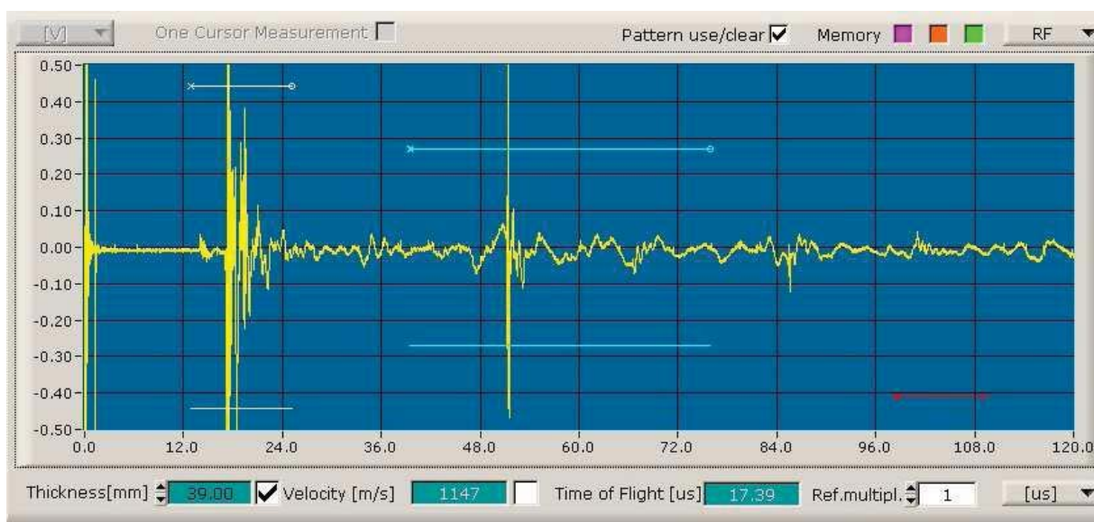
Rys. 6. Pomiary przy pomocy przetworników z linią opóźniającą - należy uwzględnić czas przejścia przez linię opóźniającą traktować jako odniesienie. W tym celu należy najpierw zmierzyć przejście przez same linie opóźniające (rys1.) Zapisać sygnał zmierzony jako wzorzec (Pattern) - w tej wersji oprogramowania wystarczy nacisnąć F7. Następnie należy ustawić układ pomiarowy jak na rysunku 7. Odniesienie (pattern) może być mierzone i wyznaczane w obydwu trybach pracy tj PE i TT.
