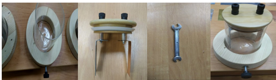
Rys. 4.4. Montaż elektrod i ogniwa galwanicznego zalewanego do stołu laboratoryjnego
