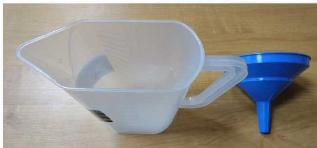
Rys. 4.5. Osprzęt służący do nalewania i zlewania elektrolitu
