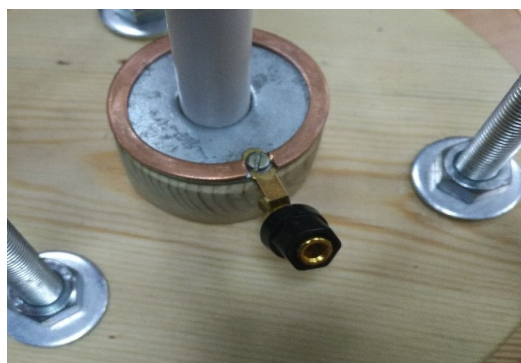
Rys. 4.9. Ogniwo galwaniczne z zaciskami pomiarowymi zaczynające i kończące stos
