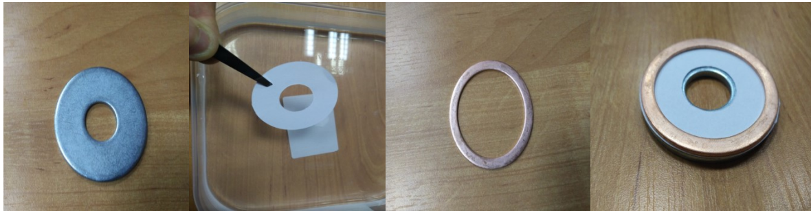
Rys. 4.10. Kolejność budowy pojedynczego ogniwa galwanicznego umieszczanego na stosie
