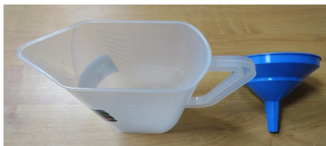
Rys. 4.8. Osprzęt służący do nalewania i zlewania elektrolitu
